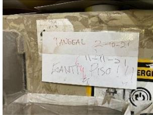
**Gambar 1.** Penjadwalan *Maintenance* Manual Mesin Cetak
