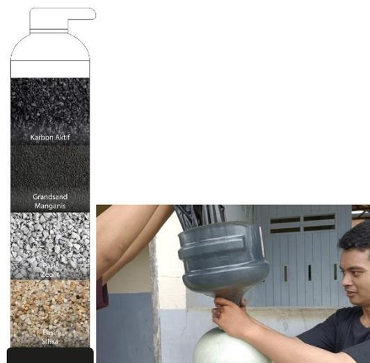
Gambar 2. Susunan material dalam tabung filter air
