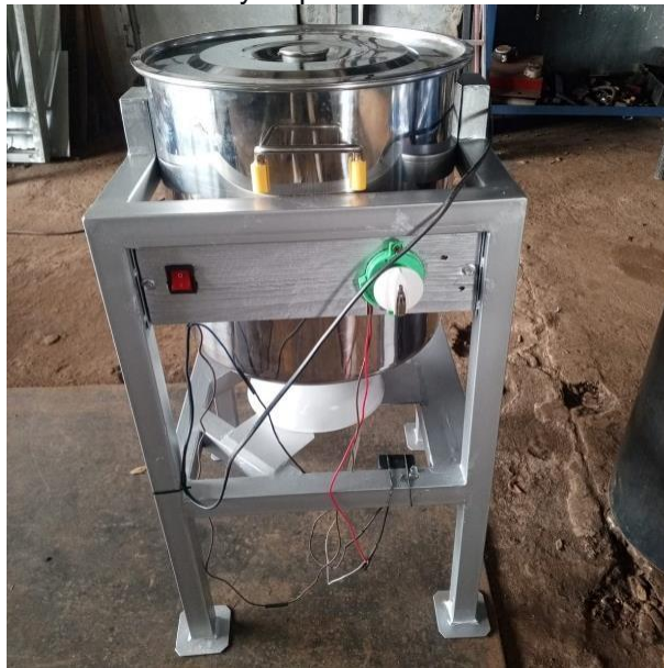
Gambar 2. Alat Peniris Minyak Hasil Pengabdian
