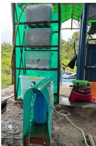
Gambar 2. Instalasi sistem pengolahan air berbasis limbah sabut kelapa ( Eco-Coco Filtration )
