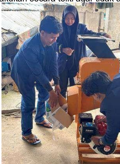
Gambar 6. (i) Proses Pemecahan/ Penghancuran Sampah Plastik dengan Mesin, (ii) Hasil dari Pemecahan Sampah
