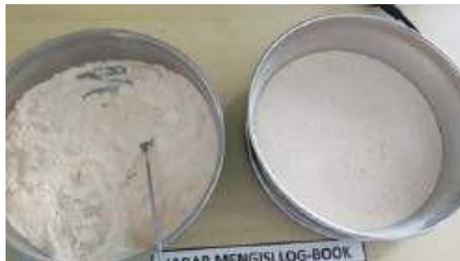
Gambar 1.5 Kiri: Sampel Cangkang Yang Belum Diayak, Kanan: Sampel Serbuk Cangkang Yang Sudah Diayak
