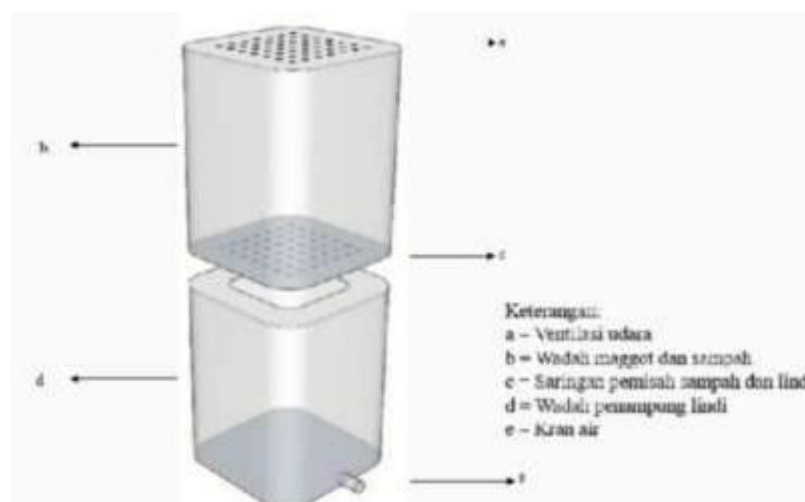
Gambar 3. Desain Reaktor Pengolahan Sampah Organik dengan Maggot sumber: (Hayati et al., 2025)
