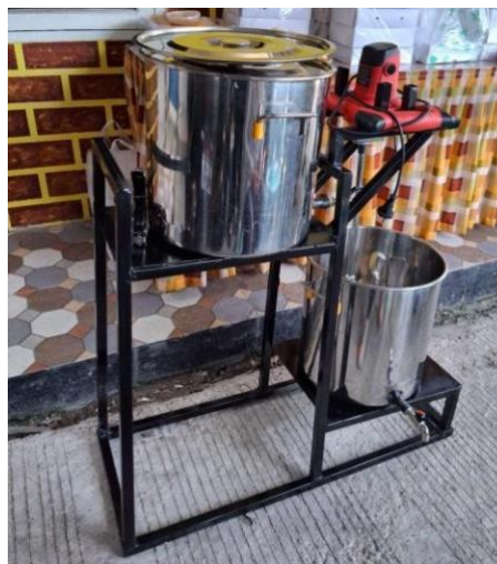
Gambar 3. Hasil Alat Reaktor Tangki Berpengaduk Sumber: Penulis, 2025
