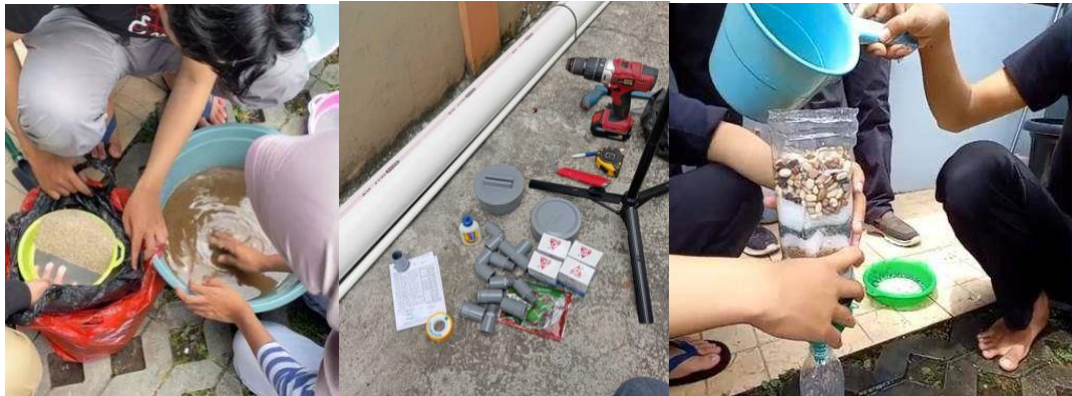
Gambar 5. Pembersihan Media Filter Air, Persiapan Tabung Filter, dan Trial Error Sumber : Dokumentasi Penulis, 2025
