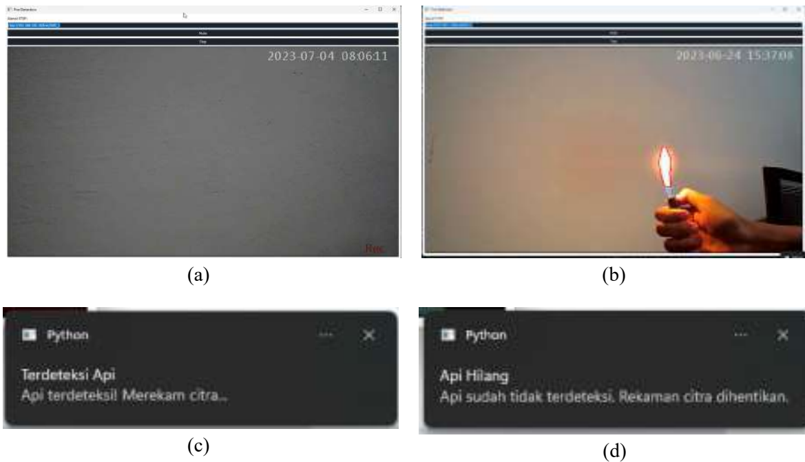
Gambar 2: Sistem Deteksi Api Berbasis CCTV, (a) Tampilan Aplikasi, (b) Tampilan Aplikasi Mendeteksi Api, (c) Pop Up Terdeteksi Api, (d) Pop Up Api Hilang
