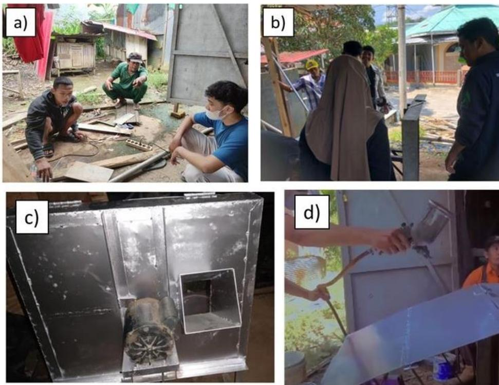
**Gambar 4.** Menunjukkan proses perakitan mesin pencacah pakan ternak kambing (a) mengukur dan dan memotong profil L; (b) menyatukan rangka(c) Menyatukan rangka dengan seluruh komponen mesin; dan (d) melakukan pengecatan seluruh bagian mesin.
