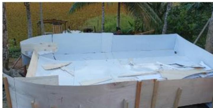
**Gambar 9. Hasil Perakitan Cetakan Perahu Lambung Katamaran**
