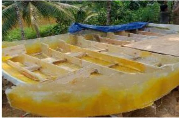
**Gambar 12. Hasil Cetakan Lambung Perahu Katamaran**
