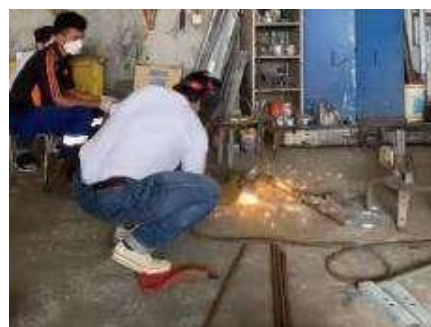
Gambar 7. Tahap Pengelasan Alat Penanam Bibit Ergonomi Sumber: Penulis, 2025
